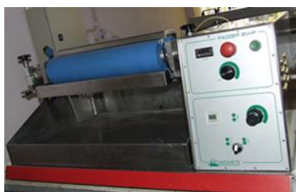
a. Fulard pentru impregnarea materialelor textile cu substante polimerice și de funcționalizare (ROACHES, Anglia)
