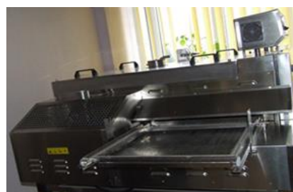
b. Aparat de uscare-termofixare-condensare pentru operatii de finisare superioara, ROACHES, Anglia)
