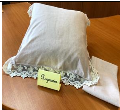
Țesături 70% bumbac/ 30% cânepă tratate cu microcapsule cu conținut de rozmarin
