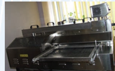
Aparat de uscare-termofixare-condensare-vaporizare (model TFO/S 500 mm) pentru operatii intermediare si finale de finisare superioara
