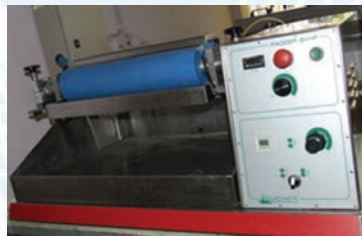
Fulard cu doua valturi oscilante vertical/orizontal (model BVHP 500/100) pentru impregnarea materialelor textile cu substante polimerice si de functionalizare
