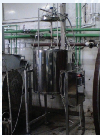
Fig. 62. - Vas de hidroliza deseuri proteice
