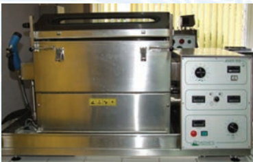
Jigher automat (latine 500 mm) pentru pregatirea si vopsirea materialelor textile in foaie lata
