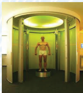
Fig. 67. Sistem mobil de masurare 3D automata a corpului (Firma producatoare Human Solutions GmbH din Germania)
