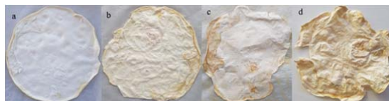
(a) disc proaspat; (b) disc pur dupa cross-link; (c) disc pur uscat si presat; (d) produs final.
