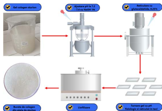
Tehnologia de obtinere a matricilor de collagen din piele de sturion
