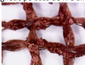
Model experimental pentru atenuare EM obtinut prin electroplacare cu cupru
