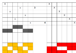
Schema de programare structura T2 – 1-legatura; 2-tragere spatia; 3-navadire; 4-legare platine; 5-cartela
