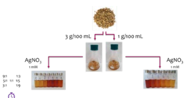
Schema de realizare a sintezei AgNPs utilizand extract apos de Stellaria media
