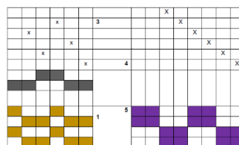
Schema de programare structura T2 – 1-legatura; 2-tragere spatia; 3-navadire; 4-legare platine; 5-cartela
