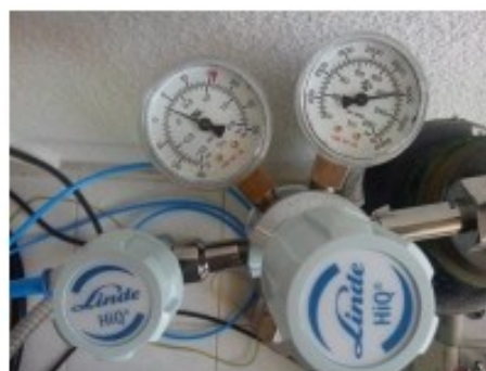
Fig. 1. Cupla rapidă utilizată la fixarea tubului flexibil (a) de racordare la reductorul buteliei de azot (b)
