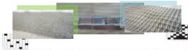
Fig. 2 Variante de inglobare a firului functionalizat pentru monitorizarea unor semnale fiziologice (legaturile saten si fagure)
