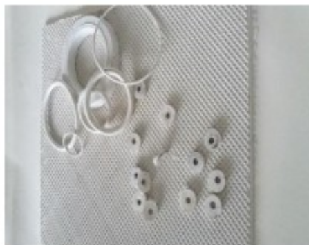
Figura 3. Produse finite fabricate din nanocompozite: garnituri de etanșare și dopuri
