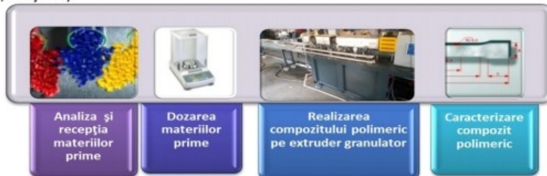
Figura 1. - Etapele procesului tehnologic de realizare a compozitelor polimerice pe extruder granulator, în fază pilot
