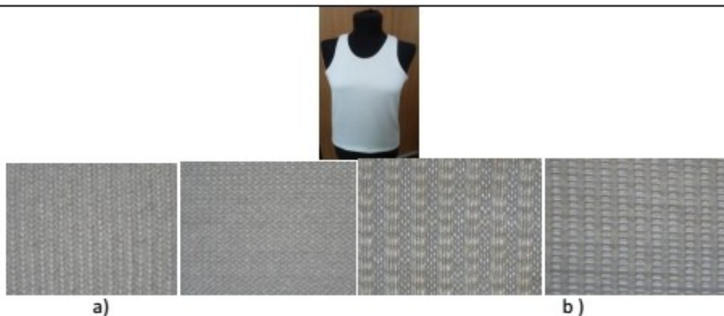
Fig. 1 Model experimental -subvestimentar cu proprieti multifunctionale utilizate ca interfata flexibila pentru atasare senzori
