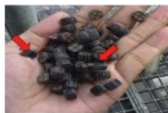
Fig.5 Formarea biofilmului pe elementele mobile
